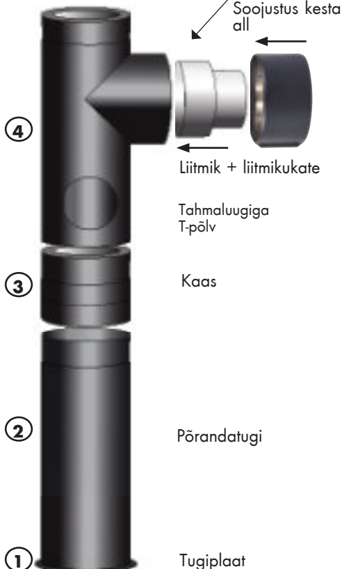
Kruvige kokku aga ainult niipalju, et liitmikukatet saab veel üles-alla liigutada
